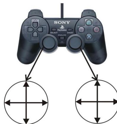
Gambar 8. Konfigurasi Potensiometer Joystick
